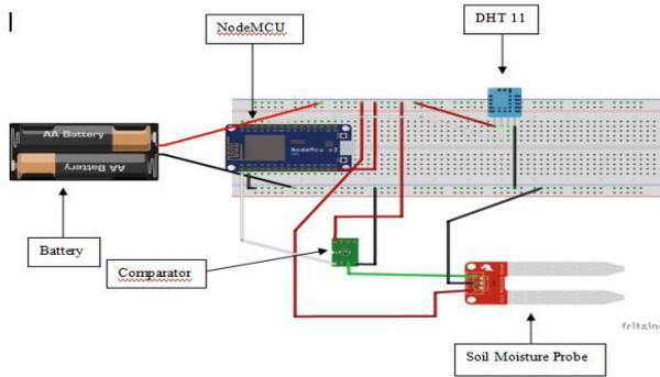
Fig:1 Virtual Circuit Diagram
