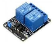
Fig-6: Relay Module
