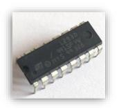
Fig. 8 Motor Driver IC
