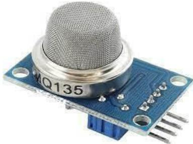
FIG 2 MQ 135 SENSOR
