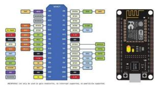
FIG 2 PIN CONFIGURATION OF NODEMCU
