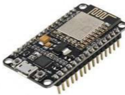
Figure 3: NodeMCU ESP8266 ESP-12E Module
