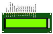
Fig. 6 LCD 16X2
