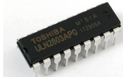
Fig. 6. ULN 2803 IC
