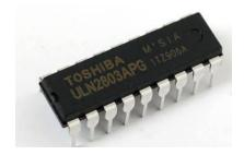
Fig. 6. ULN 2803 IC
