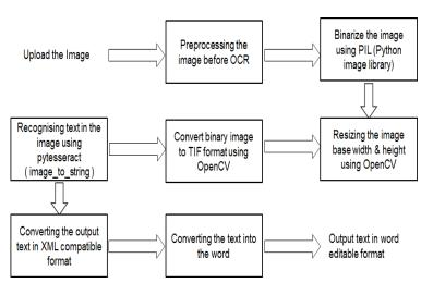
Fig. 5.1Workflow Diagram
