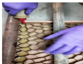
Fig-6: Pouring of PU foam
