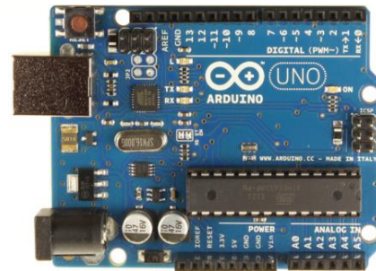
Fig .4.1 Arduino UNO
