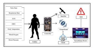
Fig. 1 Block Diagram
