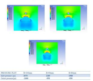
(Fig 2.2.1 PRESSURE CONTOURS)
