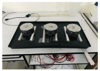
Fig. 4.2.10Sorptivity test apparatus
