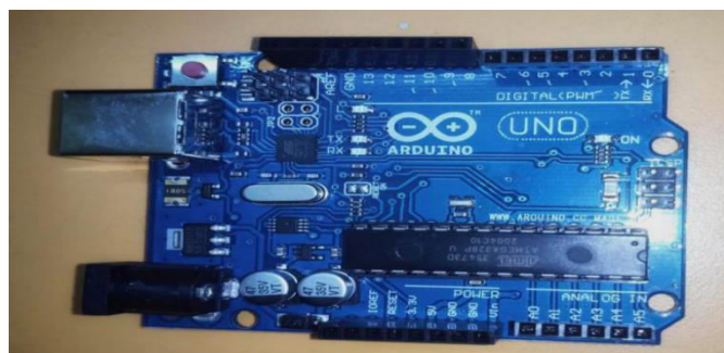
Fig -7: Arduino UNO
