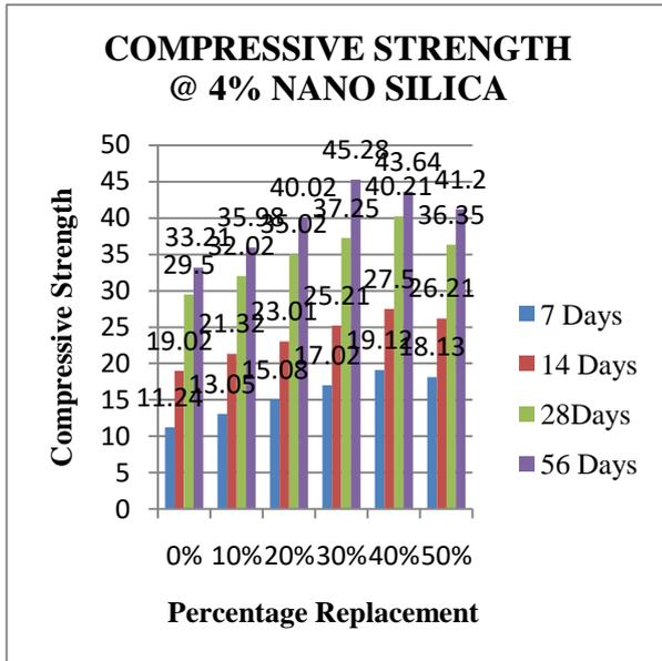
Fig.: 6.2. COMPRESSIVE STRENGTH @ M20 4% NANO SILICA
