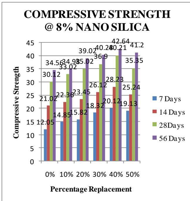
Fig.: 6.3. COMPRESSIVE STRENGTH @ M20 8% NANO SILICA
