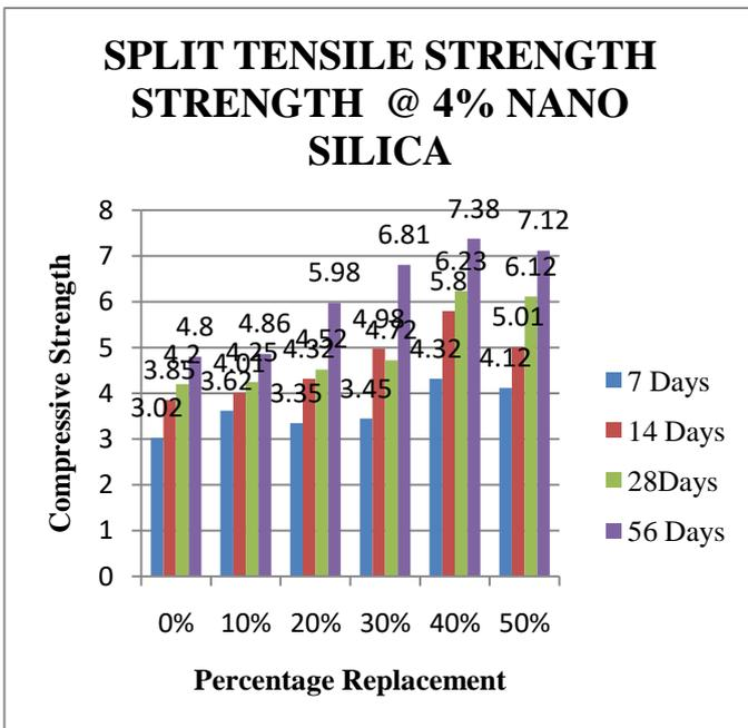
Fig.: 6.2. SPLIT TENSILE STRENGTH @M20 4% NANO SILICA
