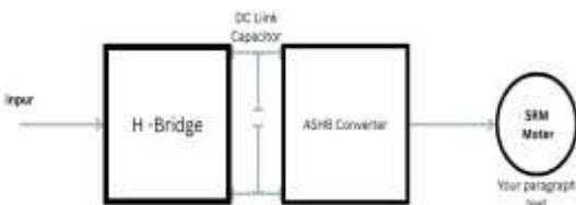
**Fig. 2. ASHB converter & H-Bridge rectifier.**
