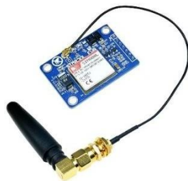
Fig 2: GSM SIM800L Module
