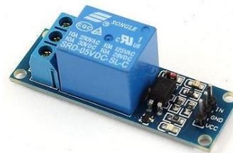
Fig 5. Relay module
