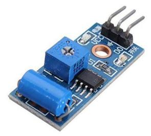
Fig: Vibration sensor
