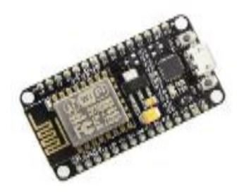
Fig 2. Nodemcu
