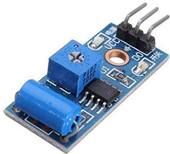
**Fig: Vibration sensor**
