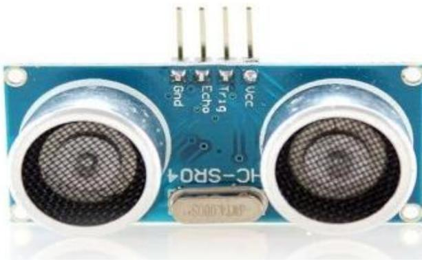
*Fig: Ultrasonic sensors*
