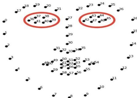
**Fig.no:2 Facial Landmark Algorithms 68-point image**
