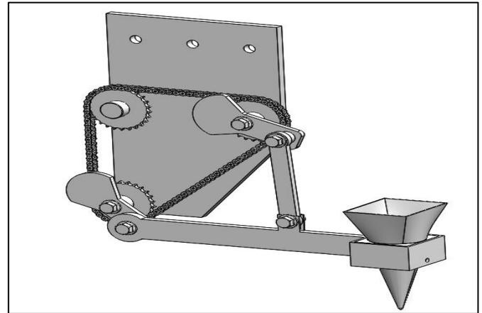
**FIGURE.3.(A) 3D MODEL OF FIVE-BAR LINKAGE SYSTEM**
