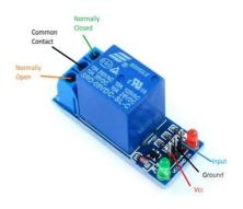
Fig. 2 5V Single-Channel Relay Module
