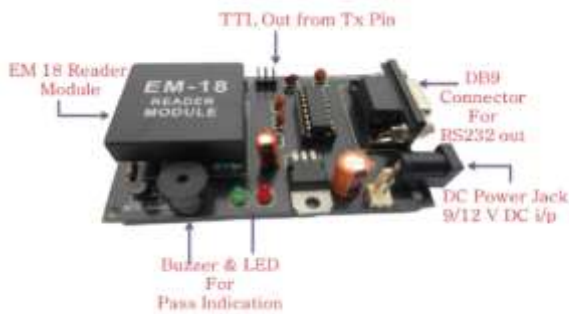
Fig -2: RFID Module EM-18
