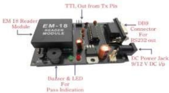
Fig -2: RFID Module EM-18
