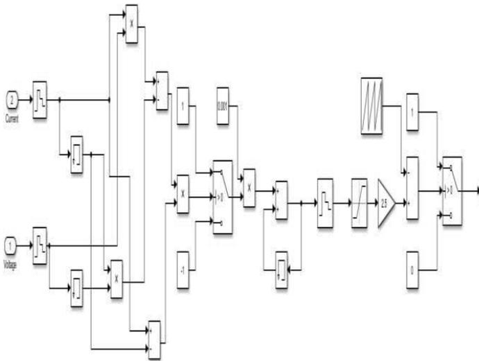
Fig: 9 P & O Matlab/Simulink
