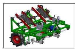
FIGURE.1 3D MODEL OF THE AUTOMATED VEGETABLE TRANSPLANTER
