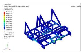
FIGURE.6.(A) LONGITUDINAL TORSIONAL STRESS
