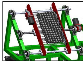
**FIGURE.4.(A) CONVEYING SYSTEM**
