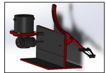
**FIGURE.4.(B) PICKUP & DROP SYSTEM**
