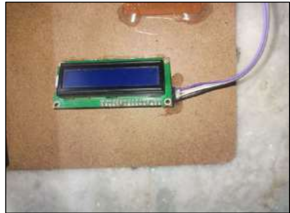
Fig: 7 LCD Display (16*2)
