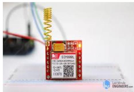
**Fig 2: GSM MODULE**
