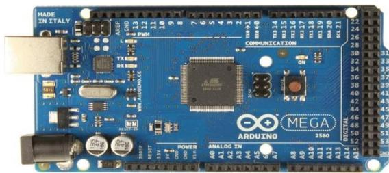
Fig 9 : ARDUINO MEGA 2560
