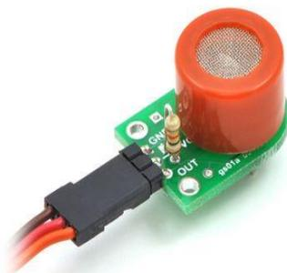
Fig. 4. CO gas Sensor
