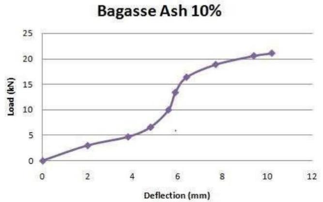
Fig. 17. Load vs Deflection – Bagasse Ash – 10%
