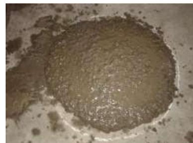
Fig. 9. Slump Flow Test
