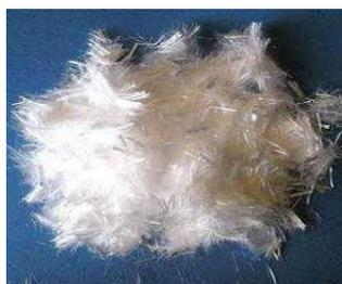
Fig. 2. Polypropylene Fibre
