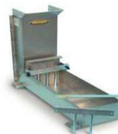
Fig. 5. L box test
