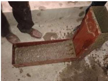
Fig. 11. L- Box Test
