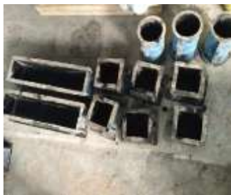
Fig. 2.3.1.1 : Oiling of Mouldes
