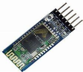
Fig. 4 Bluetooth module HC-05
