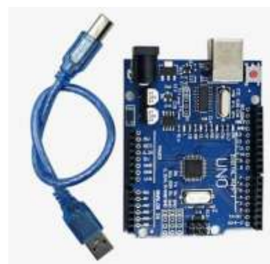
Fig -3: Arduino Uno
