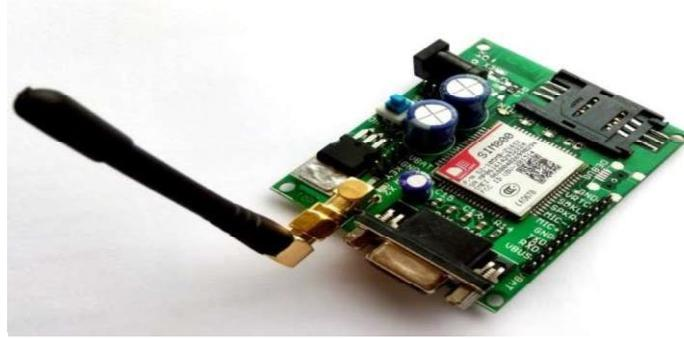
Figure : GSM Module
