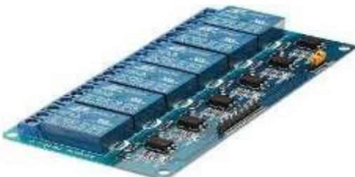
Figure 5. Relay module
