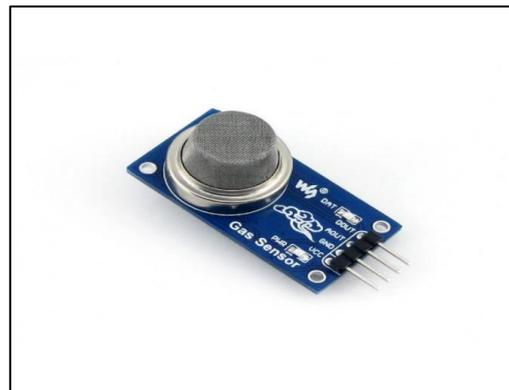
Fig-4: MQ135 GAS SENSOR
