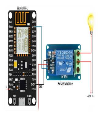
Fig 3:Interfacing Diagram Of NodeMCU(ESP8266) With Relay Module
