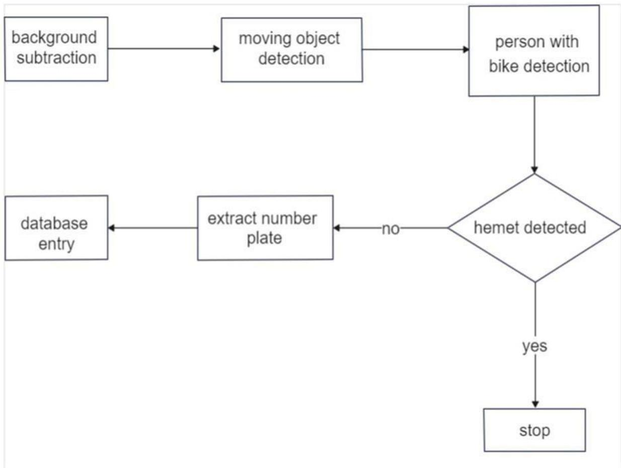
**Data Flow Diagram Of Helmet Detection**
