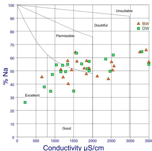
Fig. 5 Wilcox Diagram (Na %)
