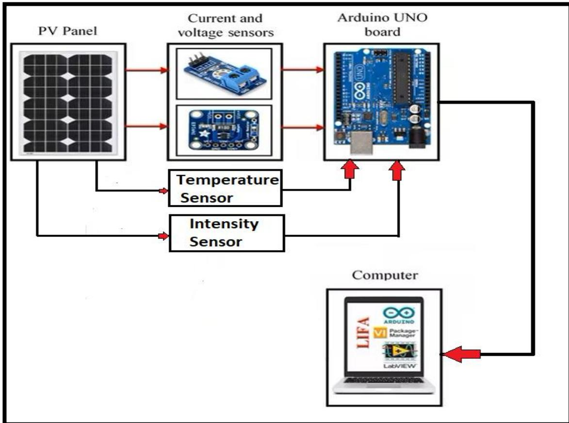
Fig. 3. Connectios Diagram
