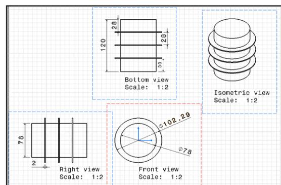
Fig. 2. Dimensions of circular fins
