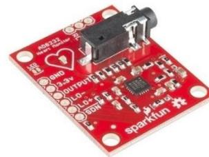
Figure.3 AD8232 ECG Module
