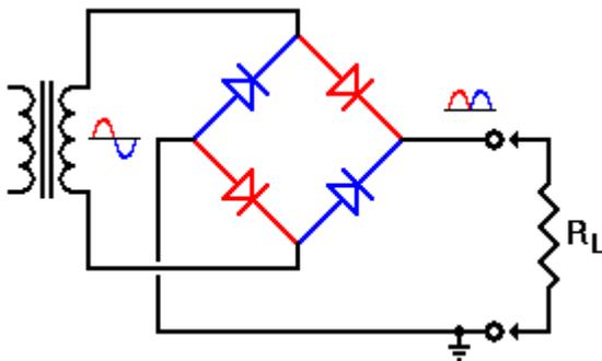
Fig 3.1.2 Bridge Rectifier
