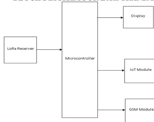
BLOCK DIAGRAM FOR LoRa RECEIVER
