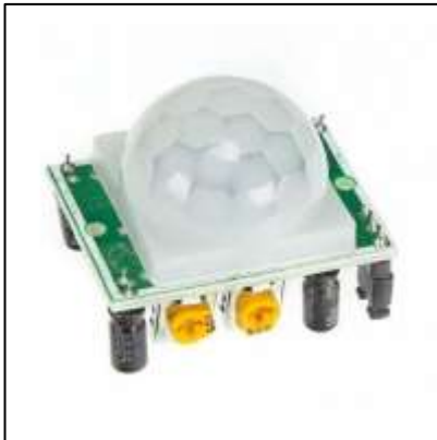
Fig: PIR Motion Sensor
