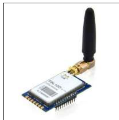
Fig: LoRa Communication Module
