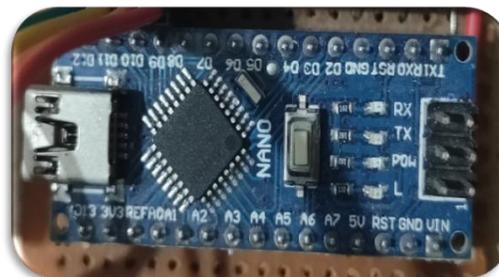
Fig.4 Arduino nano module
